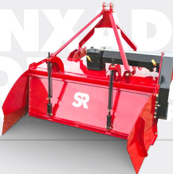
A mais prática da categoria, a linha SREE foi desenvolvida deixando o implemento com maior resistência e durabilidade. É acoplado nos três pontos do trator, trabalhando na incorporação de matéria orgânica e destorramento deixado por subsolador.
