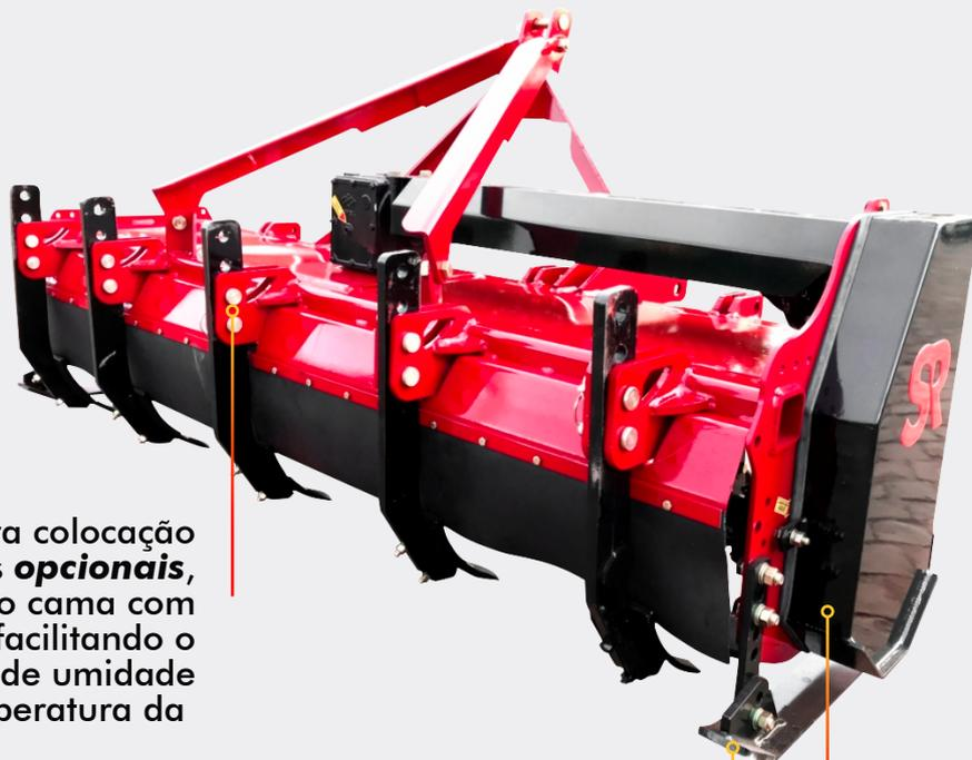
Suportes para colocação de hastes traseiras **opcionais**, deixando cama com ondulações, facilitando o controle de umidade e temperatura da
